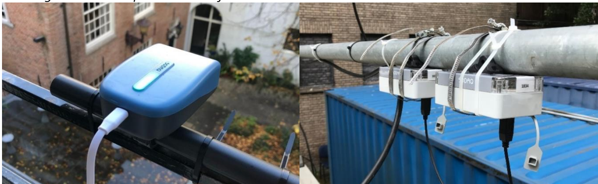
Afbeelding 3. Foto's van de geteste sensoren, met rechts 1 e generatie Sdaq snuffelfiets sensorkastjes en links 2 e generatie Sdaq Air sensorkastje.
